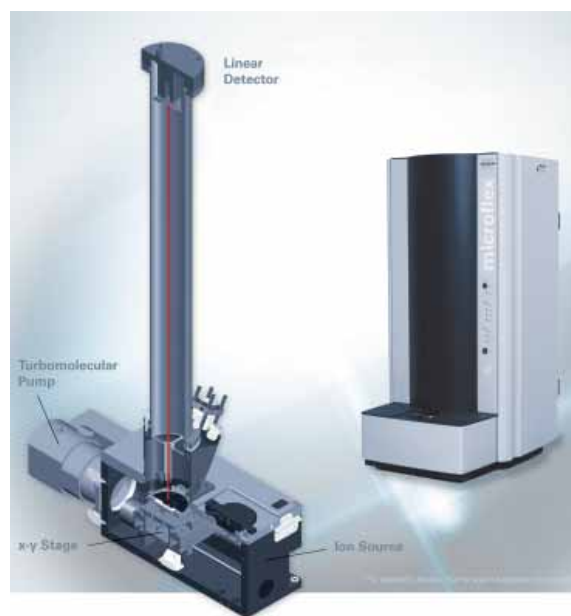
Figure 8. Le Maldi-Tof microflex LT. A l'arrière-plan, l'appareil comme s'il était sur une table de laboratoire. A l'avant-plan, une représentation en coupe. La pompe turbomoléculaire assure le vide poussé, le laser à hydrogène se trouve à l'arrière et le système, qui est appelé x-y stage, présente au laser les différents dépôts les uns après les autres.
