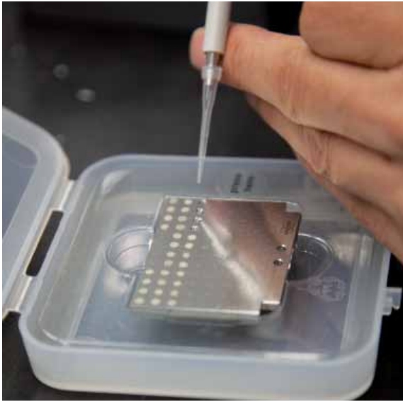
Figure 9_ La plaque-cible avec, dessus, des dépôts déjà utilisés avec des bactéries fixées dans une matrice et l'application de la matrice liquide sur les nouvelles bactéries déposées.
