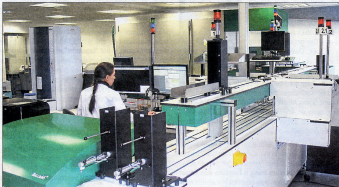
Teilansicht der Kiestra-Anlage mit dem turmartigen MALDI-ToF-Massenspektrometer links im Bild. (FOTO: KETTERHILL)
